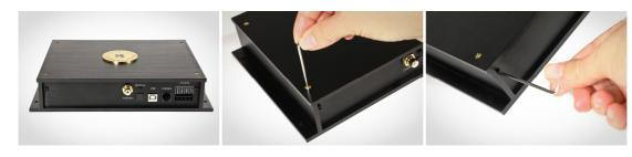
В дальнейшем базовая панель будет заменена на сменную, которая идёт в комплекте к модулю:
