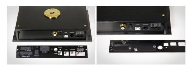
**Шаг 2.** Аккуратно отсоедините от платы разъём цифрового коаксиального входа. Запомните, в каком порядке провода идут от него к плате, в последующем их нужно будет подключить обратно. Открутите разъём с базовой панели и переставьте его на новую сменную панель.
