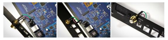
**Шаг 3.** Установите модуль Resolut A-IN как это показано на фотографии. Проследите за тем, чтобы разъёмы на модуле точно совпали с соответствующими пинами на плате процессора.
