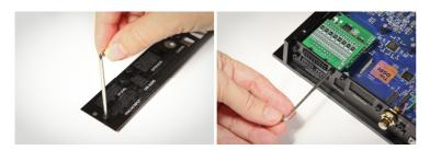
**Совет.** Сохраните базовую панель и заглушки, снятые со сменной панели. Если со временем возникнет необходимость изменить конфигурацию процессора установкой/удалением опциональных модулей, вы можете возвратить заглушки на свои места или снова установить базовую панель.
