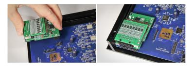
**Шаг 4.** Сменная панель имеет окна для дополнительных модулей, закрытые заглушками. Удалите заглушку с окна для разъёмов ANALOG INPUT и закрепите новую панель на корпусе процессора. Используйте крепёж, оставшийся от базовой панели и от заглушки. Не забудьте подключить разъём цифрового коаксиального входа к плате процессора.
